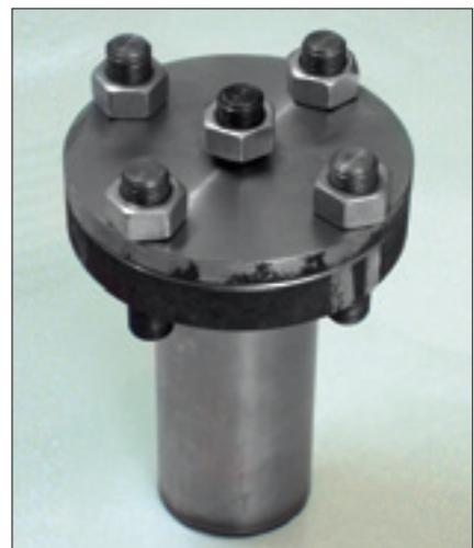
Рис. 2. Автоклавная ячейка для проведения коррозионных испытаний при повышенных температурах (а — в разобранном виде (на штоке-держателе видна изолирующая оболочка и изолирующий дистантор); б — в собранном виде, подготовленная к установке в термостат)
