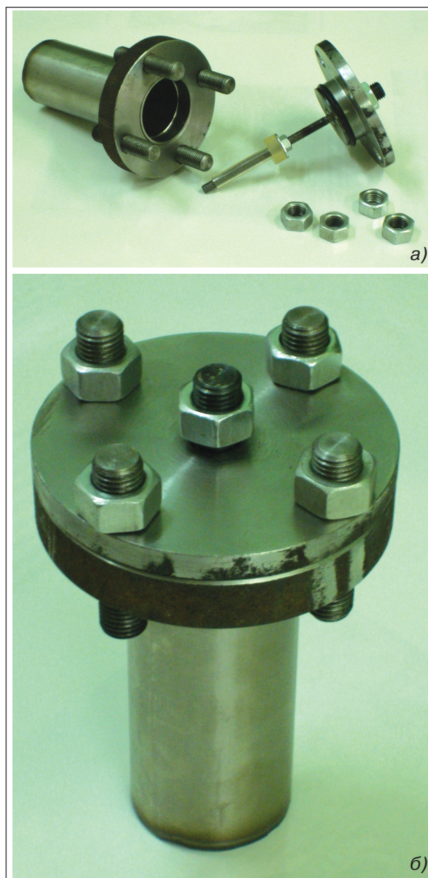
Рис. 2. Автоклавная ячейка для проведения коррозионных испытаний при повышенных температурах: а – в разобранном виде (на штоке-держателе видна изолирующая оболочка и изолирующий дистантор); б – в собранном виде, подготовленная к установке в термостат.
