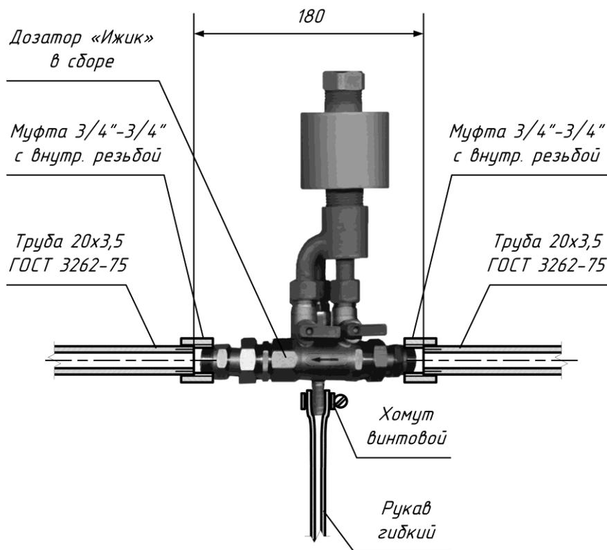
**Схема монтажа мини-дозатора «Ижик»
